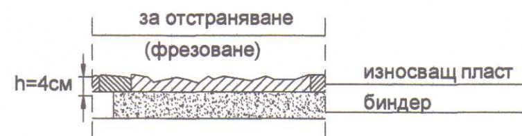
ДЕТАЙЛ No1 - Фрезование на повредени площи
